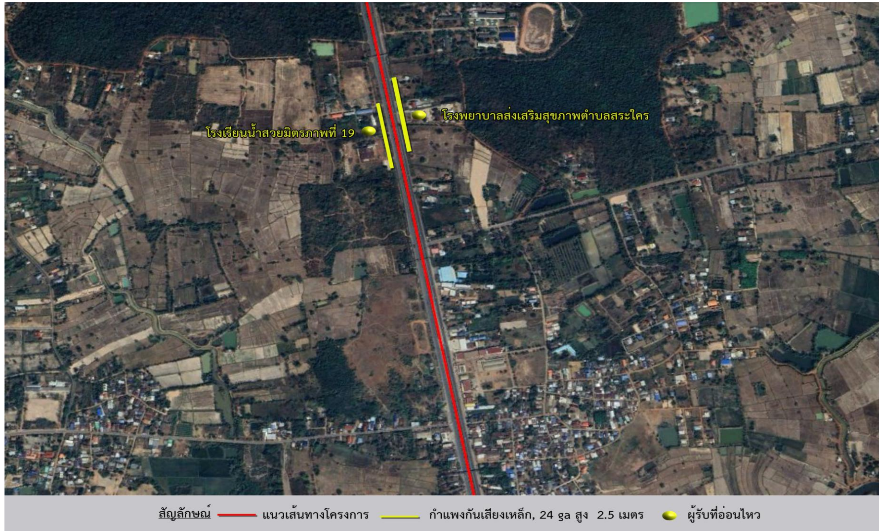
รูปที่ 4.3-4 ตำแหน่งติดตั้งกำแพงกันเสียงชั่วคราวในระยะก่อสร้าง
