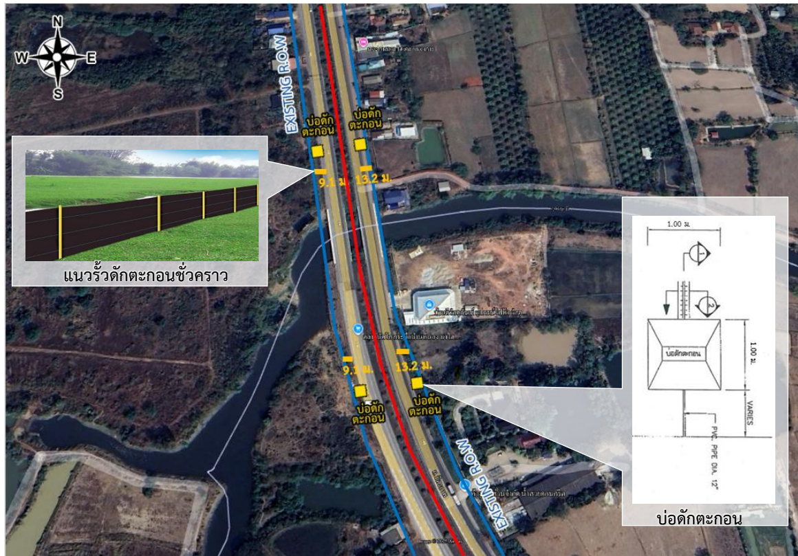
รูปที่ 5.3.1-4 ตำแหน่งติดตั้งรั้วดักตะกอนชั่วคราวแบบ Temporary Silt Fence และบ่อดักตะกอนบริเวณลำน้ำสวย (กม.486+350)
