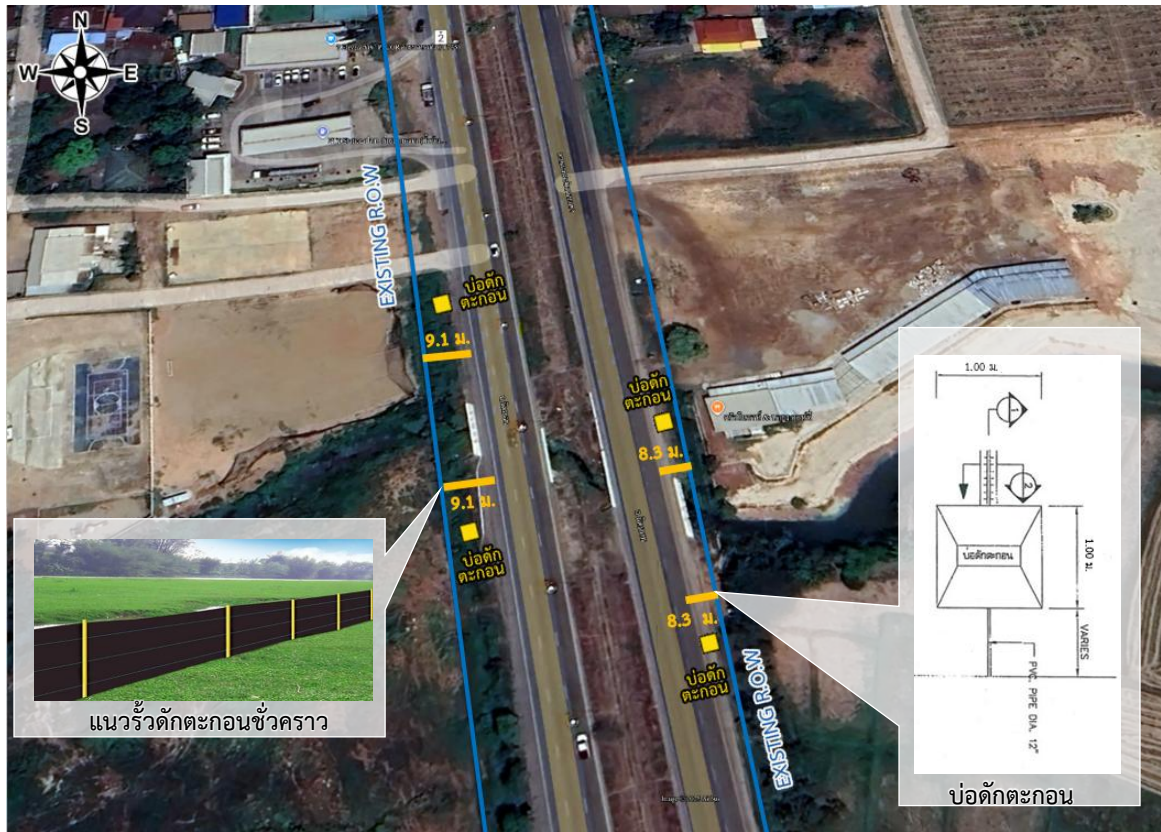
รูปที่ 6.2-4 ตำแหน่งติดตั้งรั้วดักตะกอนชั่วคราวแบบ Temporary Silt Fence และบ่อดักตะกอนบริเวณห้วยสองห้อง (กม.495+808)
