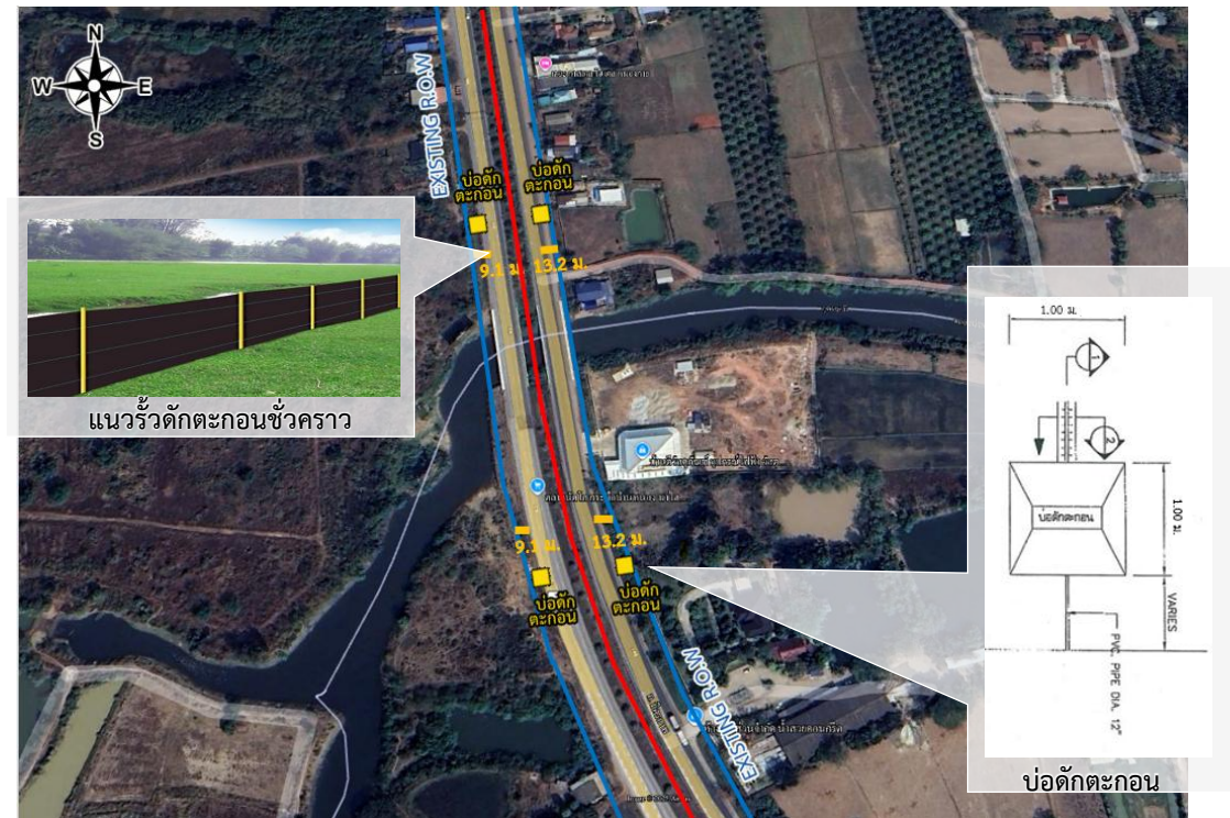
รูปที่ 6.2-2 ตำแหน่งติดตั้งรั้วดักตะกอนชั่วคราวแบบ Temporary Silt Fence และบ่อดักตะกอนบริเวณลำน้ำสวาย (กม.486+350)
