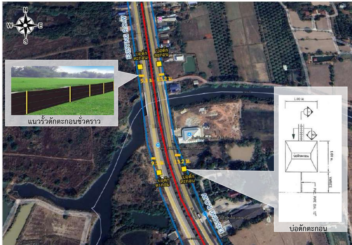
รูปที่ 5.3.1-4 ตำแหน่งติดตั้งรั้วตักตะกอนชั่วคราวแบบ Temporary Silt Fence และบ่อดักตะกอนบริเวณลำน้ำสวย (กม.486+350)
