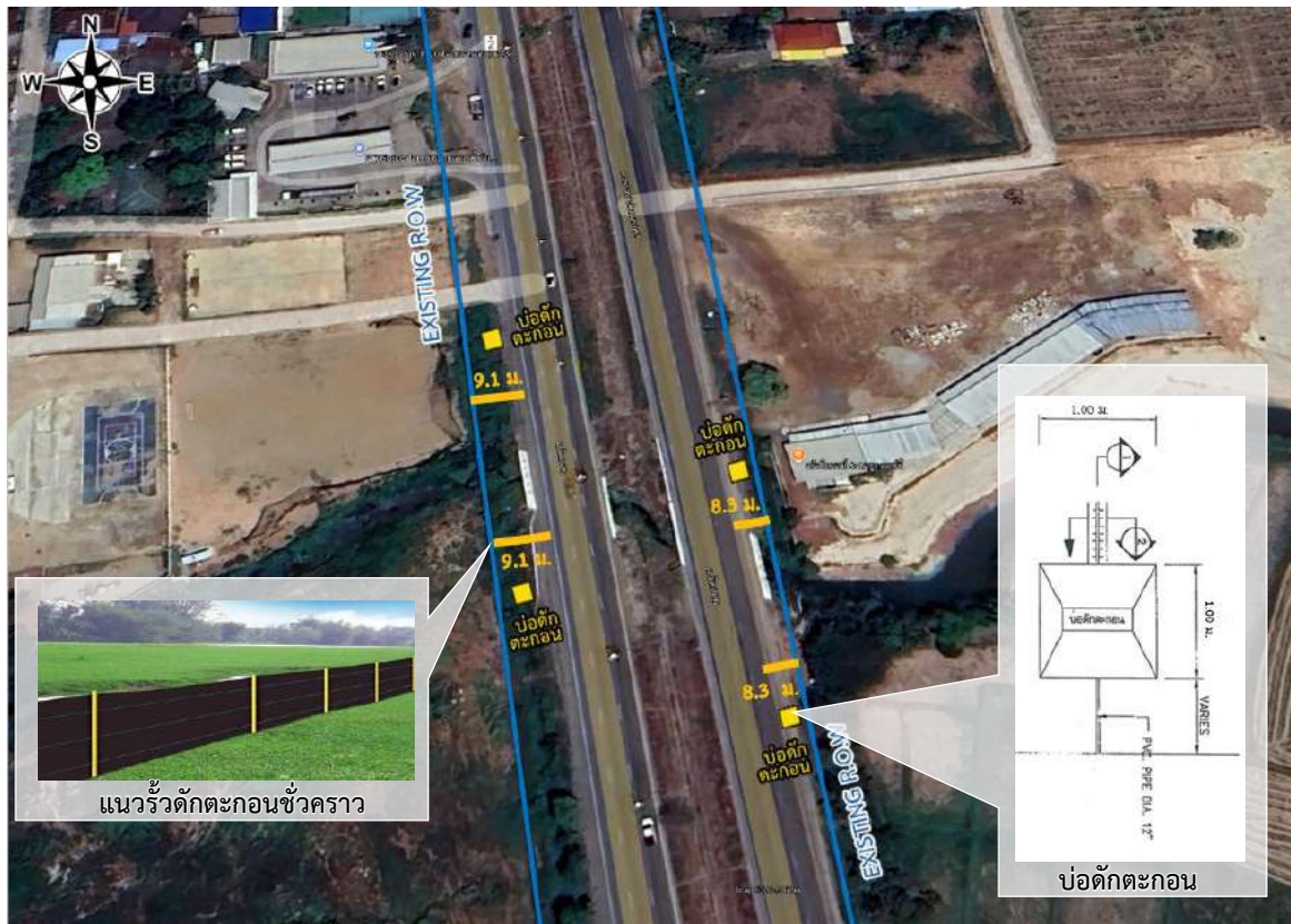
รูปที่ 5.3.1-6 ตำแหน่งติดตั้งรั้วดักตะกอนชั่วคราวแบบ Temporary Silt Fence และบ่อดักตะกอนบริเวณห้วยสองห้อง (กม.495+808)
