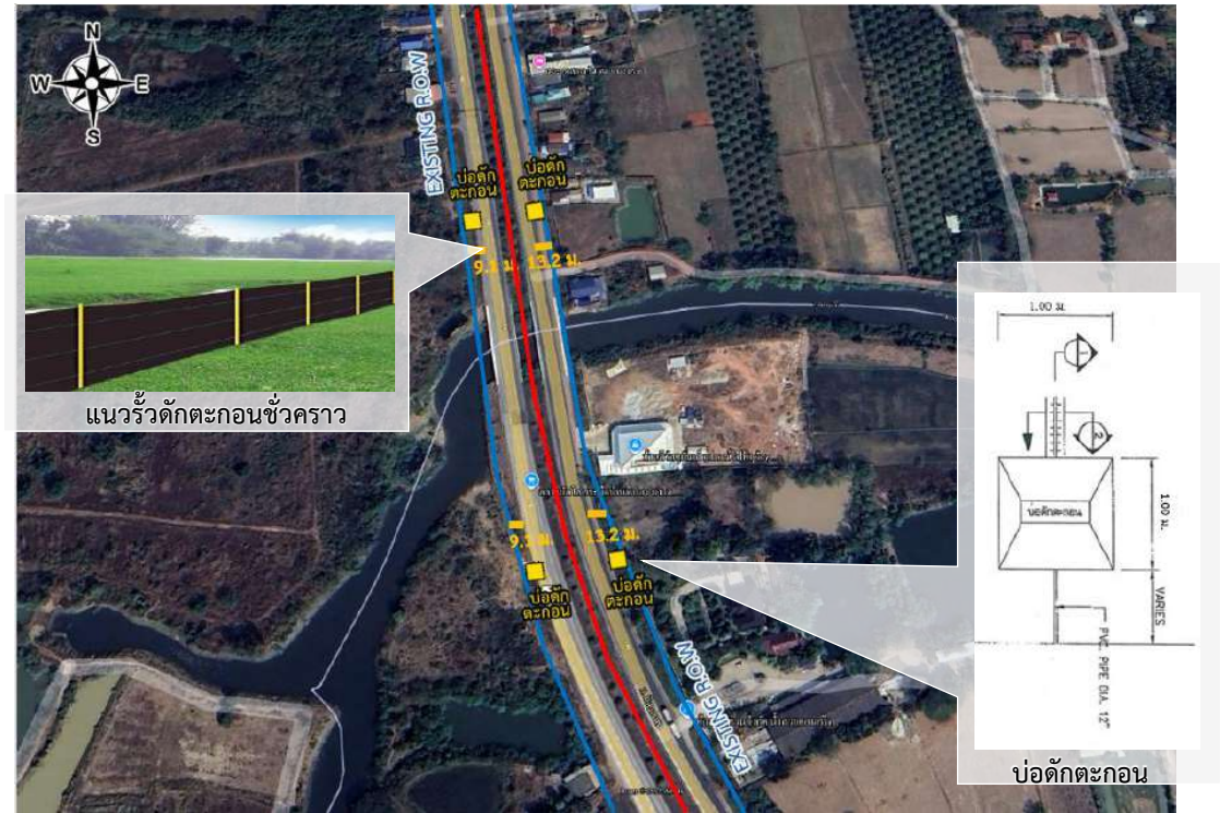
รูปที่ 6.2-2 ตำแหน่งติดตั้งรั้วดักตะกอนชั่วคราวแบบ Temporary Silt Fence และบ่อดักตะกอนบริเวณลำน้ำสวย (กม.486+350)
