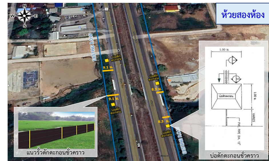
ติดตั้งรั้วดักตะกอนชั่วคราว แบบ Temporary Silt Fence
