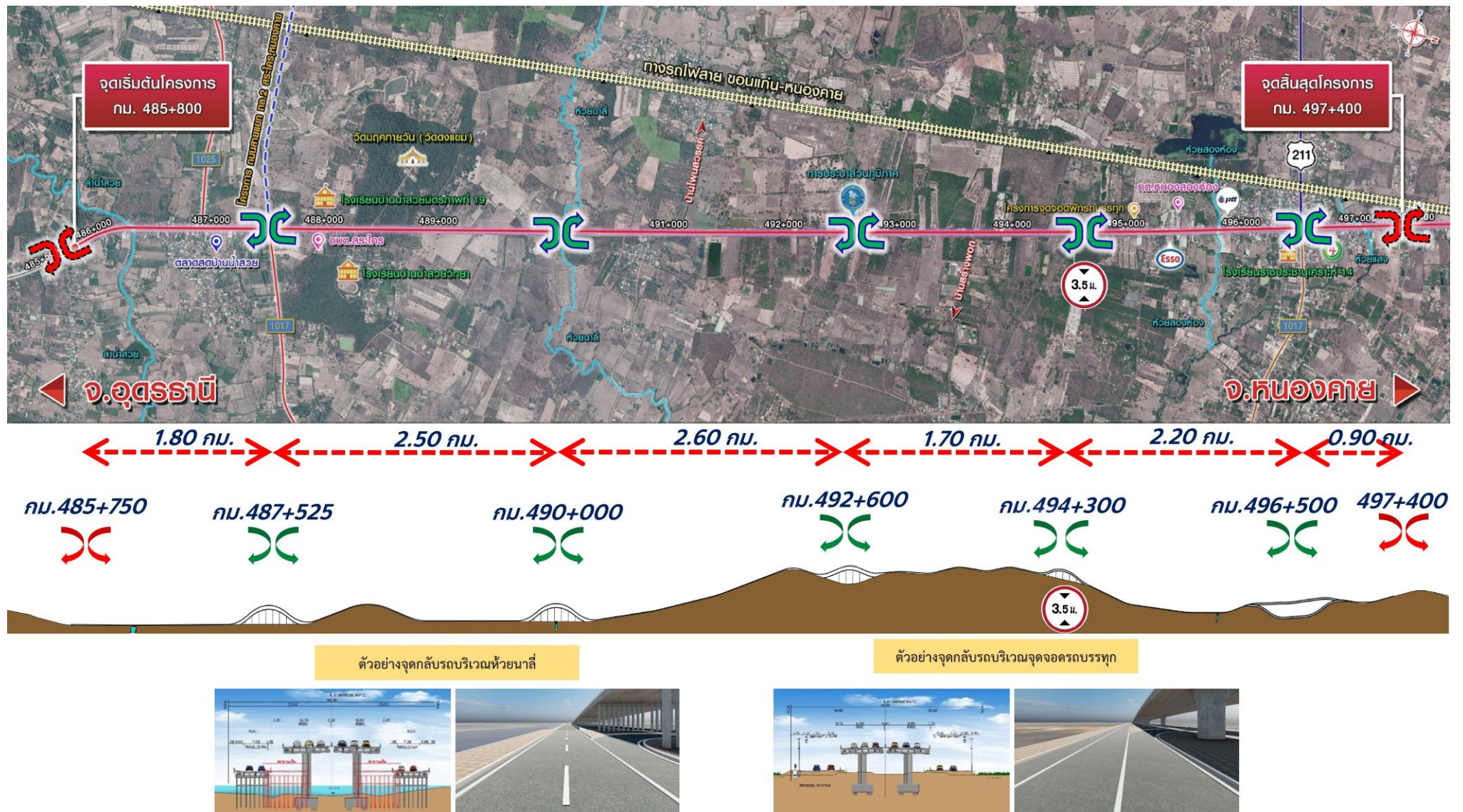
รูปที่ 5-3 ตำแหน่งและรูปแบบจุดกลับรถในโครงการ
