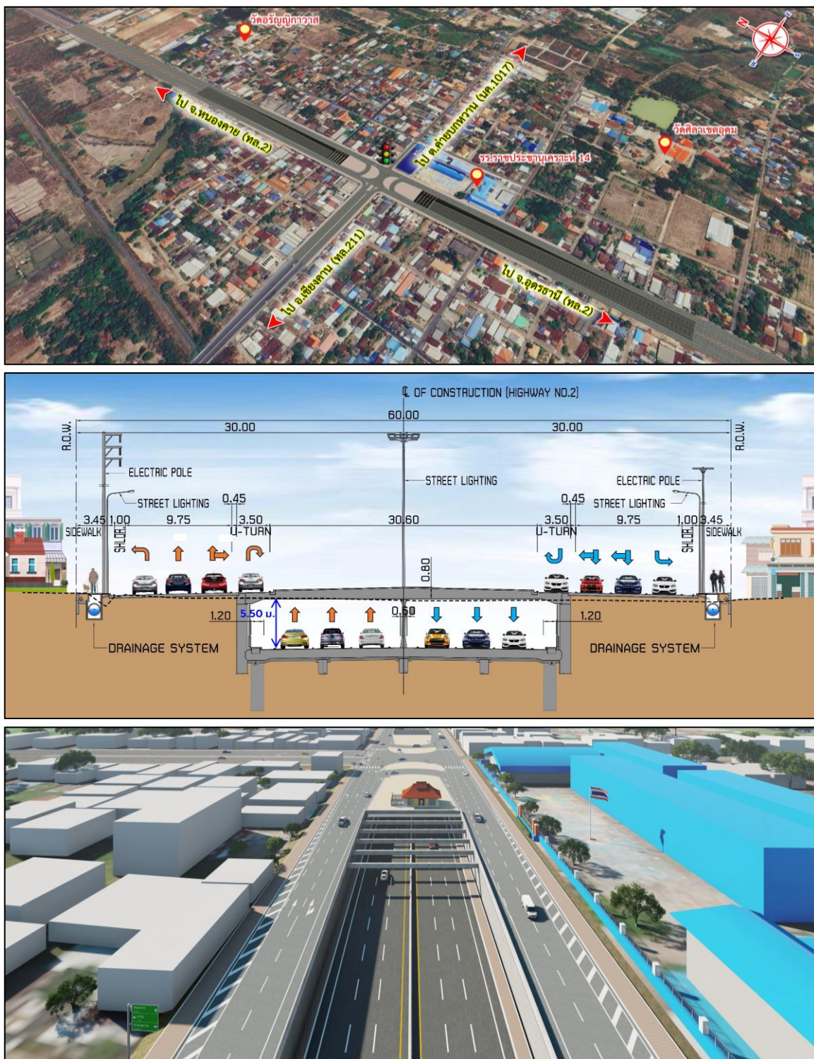
รูปที่ 5-6 รูปแบบทางแยกต่างระดับบริเวณทางแยกหนองสองห้อง
